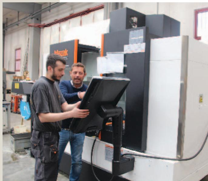
L'operatore programma sostanzialmente a bordo macchina sfruttando l'intuitività dell'interfaccia Mazak
