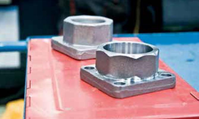
*Particolari per il settore valvole: pezzo forgiato grezzo e finito, eseguiti con il centro di tornitura Multiplex Triple 8200Y di Mazak*
