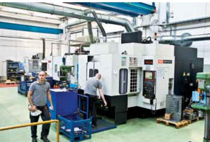
*Il centro di lavoro verticale multitasking Variaxis 630 5X II è capace di eseguire lavorazioni simultanee su cinque assi estremamente precise e complesse, grazie a una tavola rotante con unità a trasmissione diretta (DD drive), in grado di raggiungere i 1.100 giri/min*
