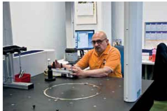
*Officina Meccanica Lamera dispone di una moderna sala metrologica climatizzata, dotata di macchina di misura tridimensionale e di altre classiche apparecchiature di controllo*
