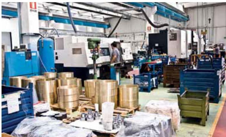
*Cybertech Turn 4500 di Mazak è una serie di centri di tornitura CNC particolarmente adatti per lavorazioni a forte asportazione di truciolo per particolari di grandi dimensioni*
